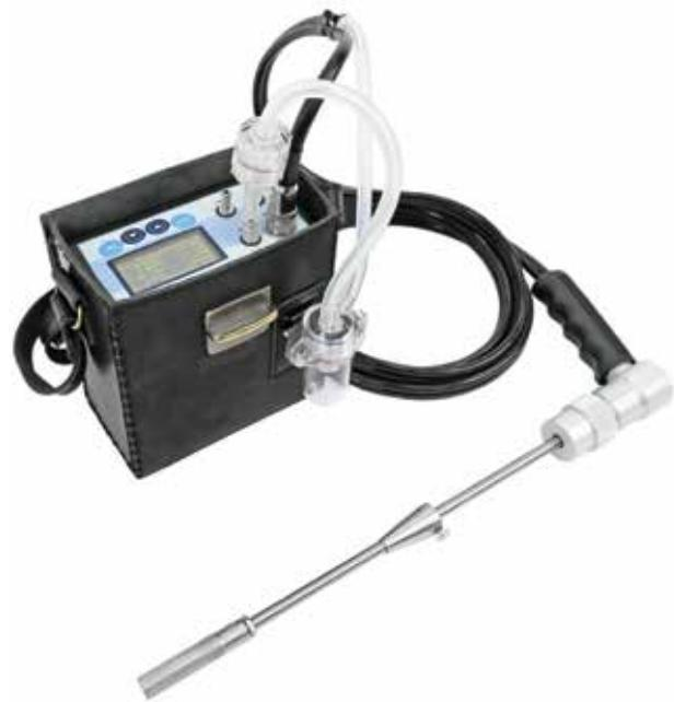
Конструктивно газоанализаторы являются одноблокочными приборами, выполненными в прочных пластиковых корпусах. На лицевую панель приборов выведены: дисплей, клавиатура, соединительные штуцера и разъем для подключения термопреобразователя, на боковые – разъем для подключения зарядного устройства и отверстие сброса пробы.
